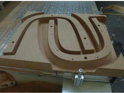
USINAGE CN DE PIÈCE TECHNIQUE
